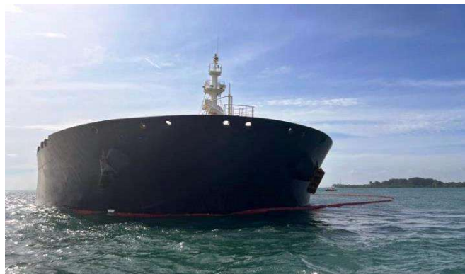
Un barrage anti-pollution a été installé autour du pétrolier. (Photo : Garde-côtes indonésienne)
