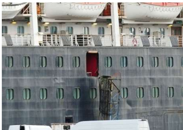
La coupée du Renaissance en pendant le long du bord devra être remontée avant le retour à quai. (Photo : pss-archi.eu)
