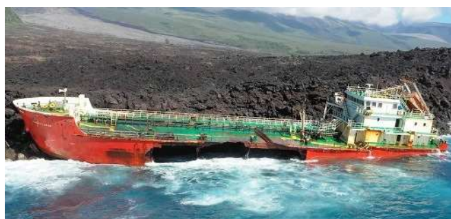
L'épave avec sa muraille bâbord partiellement arrachée, vue au printemps 2022.
