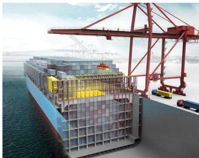
Le système de stockage de conteneurs de Hyundai élimine la tâche fastidieuse du saisissage des conteneurs. (Image : Hyundai Heavy Industries)
