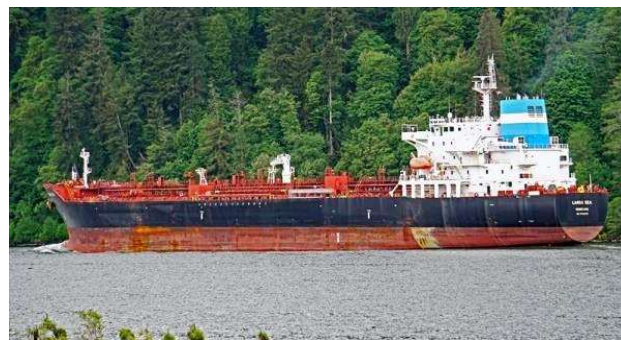
Le Largo Sea, pétro-chimiquier construit en 2016, navigue sous pavillon du Libéria. Il mesure 183 m de long et 32,20 m de large pour un port en lourd de 49 990 t. Il est vu ici le 11 mai 2020. (Photo : Marine Traffic)
