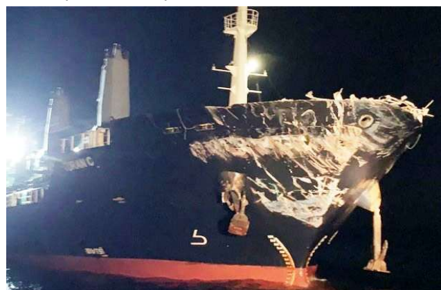
Les dégâts sur l'étrave de l'abordeur, le Turan C. (Photo : FleetMon)
