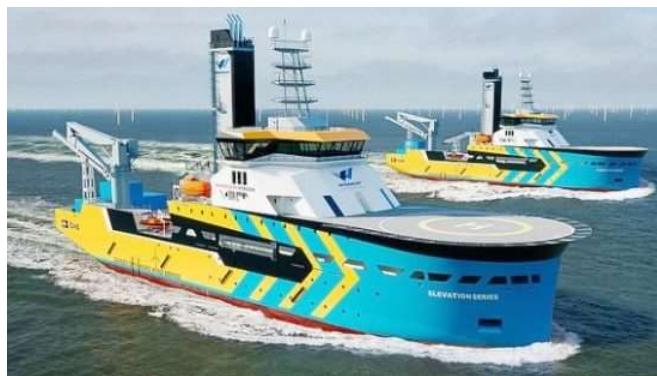
Les 2 premiers navires de la série innovante Elevation équipés de moteurs à hydrogène dual-fuel devraient être livrés à partir de 2025. (Image : Damen)
