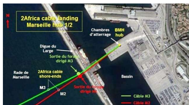
Atterrissage du câble 2Africa à Marseille. (Image : philBE2)
