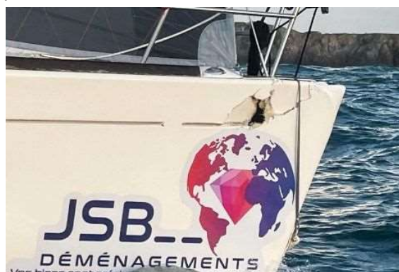
La collision intervenue dès les premiers instants de la course a causé ce trou dans la coque du bateau de Jean-Sébastien Biard. (Photo : DR)
