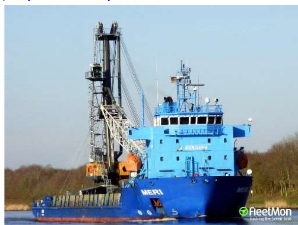
Vue du transport de colis lourds Meri déjà chargé d'une grue. Construit en 2012, il mesure 105,40 m de long pour 18,80 m de large avec un port en lourd de 4 835 t et arbore le pavillon finlandais. (Photo : FleetMon)
