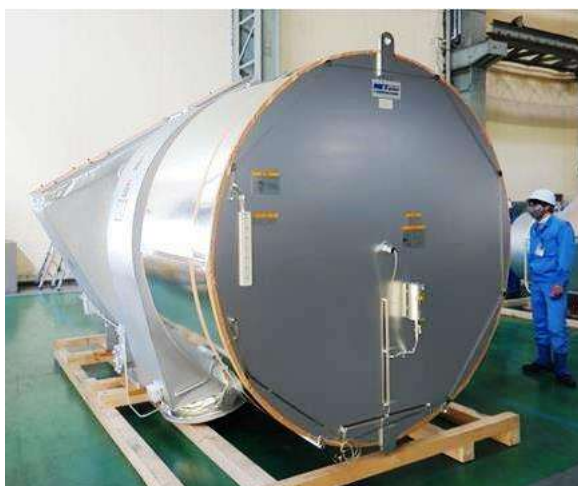
La turbosoufflante MET90MB dont la taille est à comparer au technicien.
