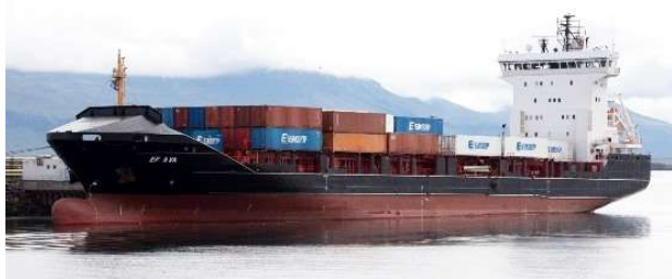
Le porte-conteneurs Ef Ava est un feeder construit en 2008 qui navigue sous pavillon du Portugal/Madère. Il mesure 129,59 m de long et 20,83 m de large pour une capacité de 698 EVP. (Photo : Capt. Hilmar Snorrason)
