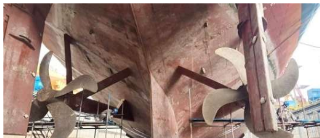
Le Marion Dufresne en cale sèche nous montre ses hélices et ses safrans. (Photo : TAAF)
